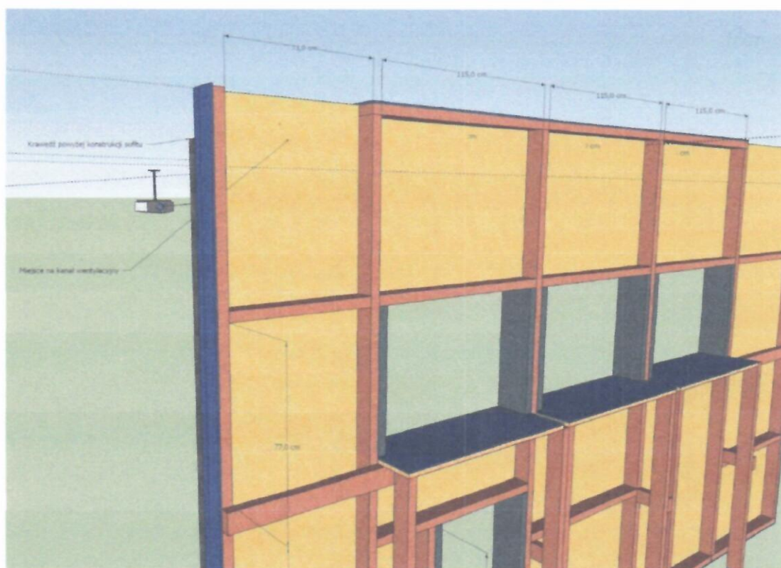
Rysunek 18: Otwór na głośniki 77 cm, miejsca na ewentualne kanały wentylacyjne (wytyczne, wykonać zgodnie z projektem)
